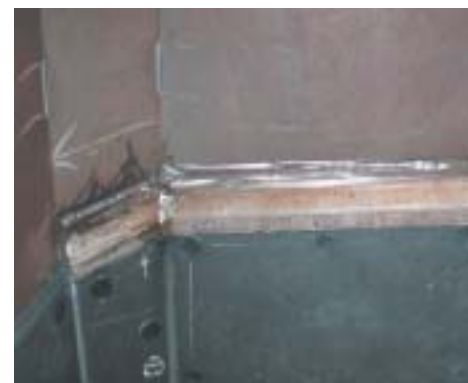
Protección metálica del borde para prevenir que el material a granel se introduzca tras el revestimiento
