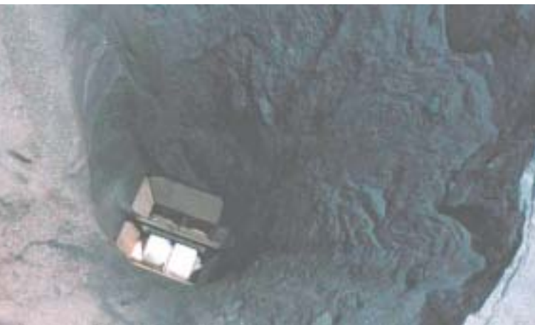
Madriguera: El centro del depósito se vacía primero generando la forma de un embudo Photo: Courtesy of Solids Handling Technologies, Inc.
