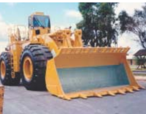
Pala excavadora revestida para evitar la adherencia del material
